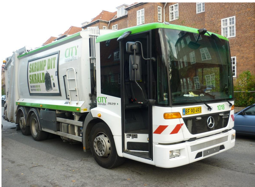
Renovationsbil med lav førerplacering, lave rudekanter og højre fordør i glas
